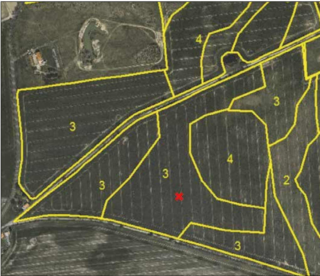
Abb. 16: Die GPS- gestützte Bodenprobenahme ermöglicht das Auffinden der zu untersuchenden Teilschläge und ggf. der vorgeplanten Probeentnahmestellen
