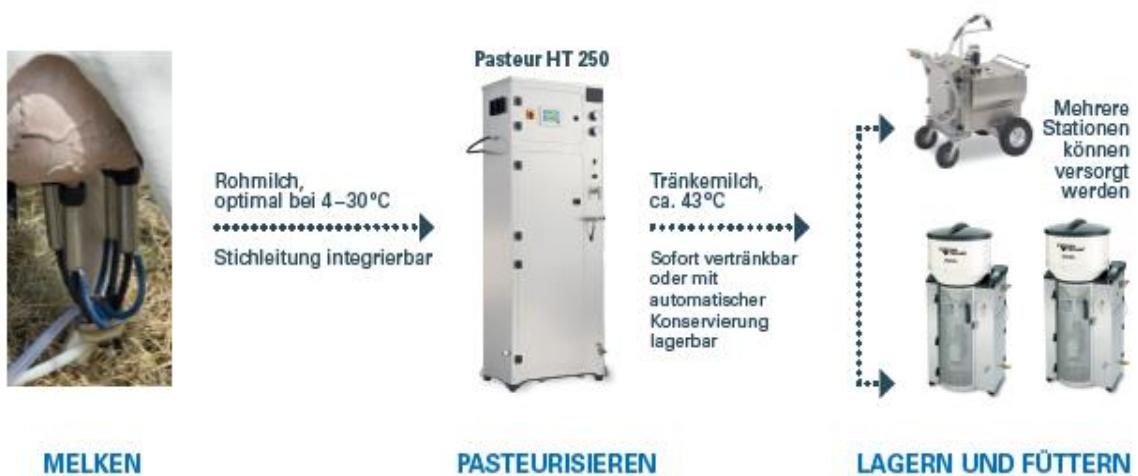
Abbildung 7: Der HT 250 (M. Förster), Systembild mit Kopplung von TA und Milchtank
